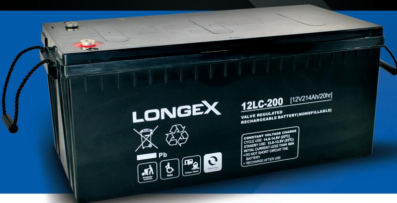
Bei dem LONGEX Akku 12LC-200 handelt es sich um einen AGM Akku (Blei-Vlies), der speziell für den zyklischen Einsatz konzipiert wurde. Durch den Einsatz spezieller Blei-Platten und der Verwendung eines besonderen Elektrolyts, weist der Akku eine besonders hohe Lebensdauer und Zyklenfestigkeit auf.
